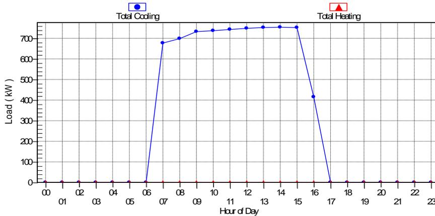
الشكل 3 الحمل الحراري للمبني المنشأ من الطوب الاسمنتي المفرغ والمطلي باللون المتوسط
