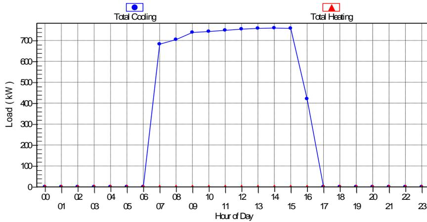
الشكل 2 الحمل الحراري للمبني المنشأ من الطوب الاسمنتي المفرغ والمطلي باللون الغامق
