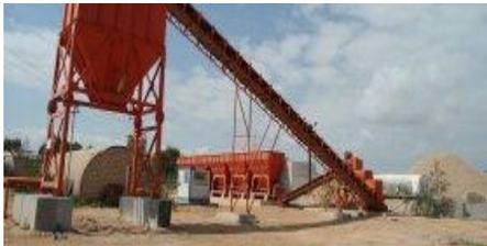
تقوم بإنتاج التربة الزلطية وهي ذات قدرة إنتاجية تصل إلى (3م/150) بالساعة وهي توفر للشركة احتياجاتها من التربة الزلطية .
