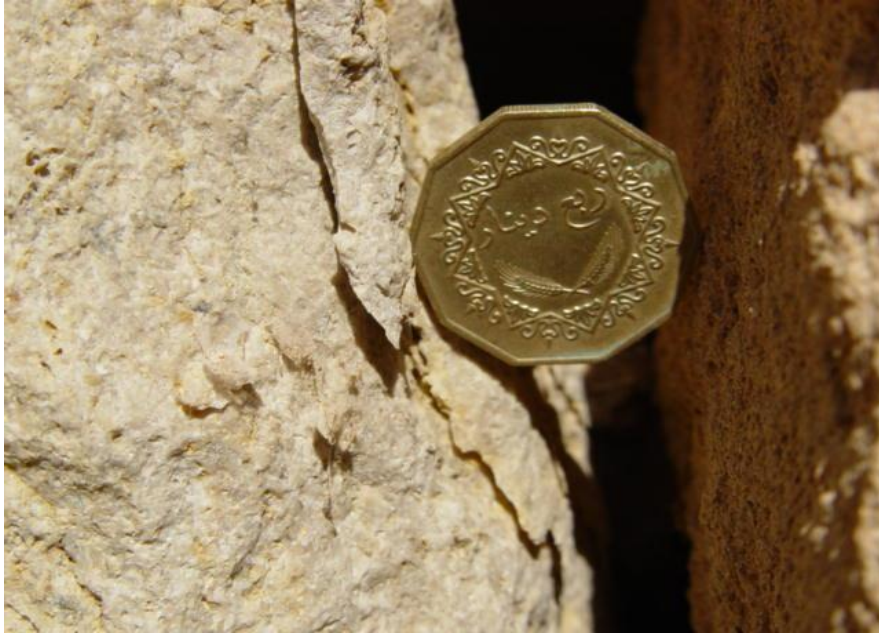
شكل (2. 13) تقشر الجزء المعرض للجو من الصخر وتفتته وانفصاله عن السطح.
