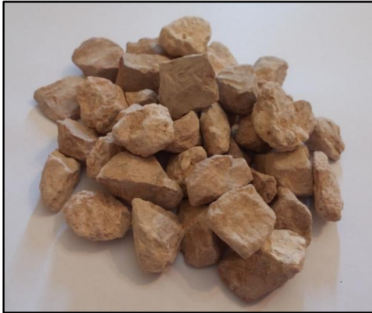
شكل (5) الركام الخشن المستعمل في إنتاج الخرسانة قيد الدراسة
