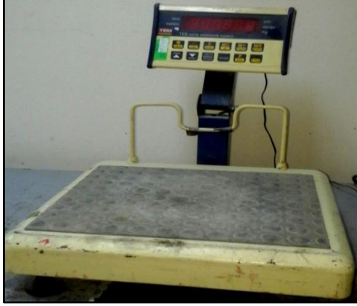
شكل (9) الميزان الالكتروني الكبير المستخدم في وزن مواد الخلط ذات الأوزان الكبيرة.
