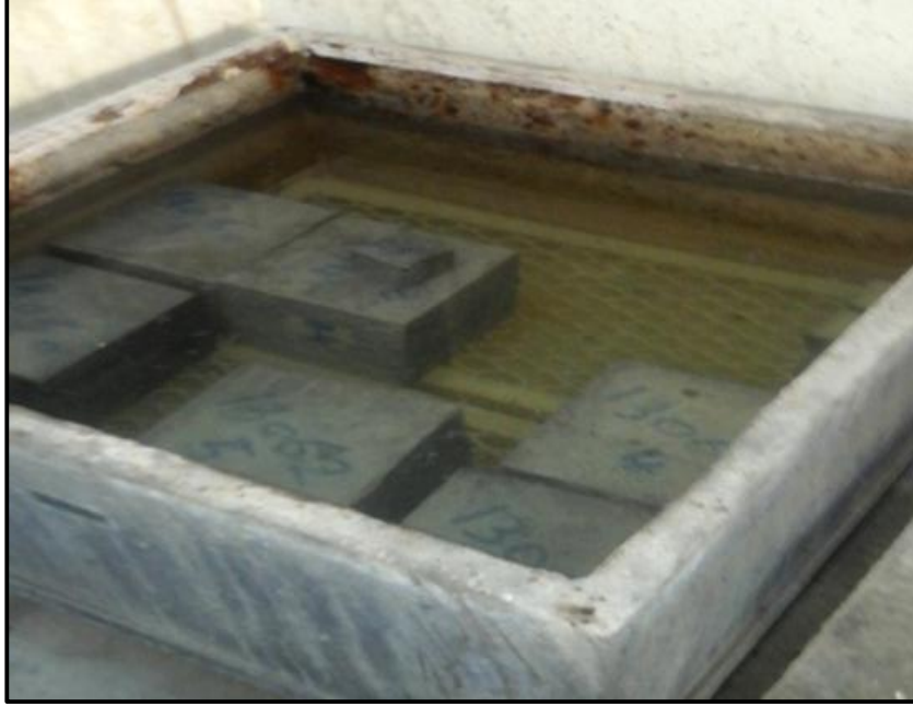
شكل (15) أحواض مياه حفظ العينات
